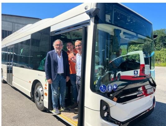
AIR Campania ha testato per la prima volta nel capoluogo irpino un bus di ultima generazione ad emissioni zero. Si tratta dell'E-Way di Heuliez modello GX137 Full Electric, messo a disposizione dell'azienda regionale di Tpl dalla Iveco, dotato di un motore Siemens IDB2016 sincrono trifase da 160 kW, con batteria di trazione Forsee Power.
